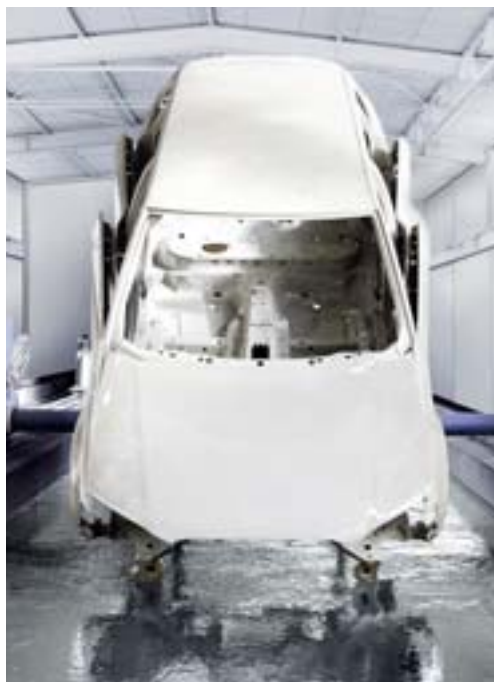
Zu den Referenzkunden von trans auriga gehört der Lackieranlagenhersteller Dürr, bei dessen Tauchlackierverfahren sich die Karosserie im Tauchbecken um die eigene Achse dreht (Foto: Dürr)
